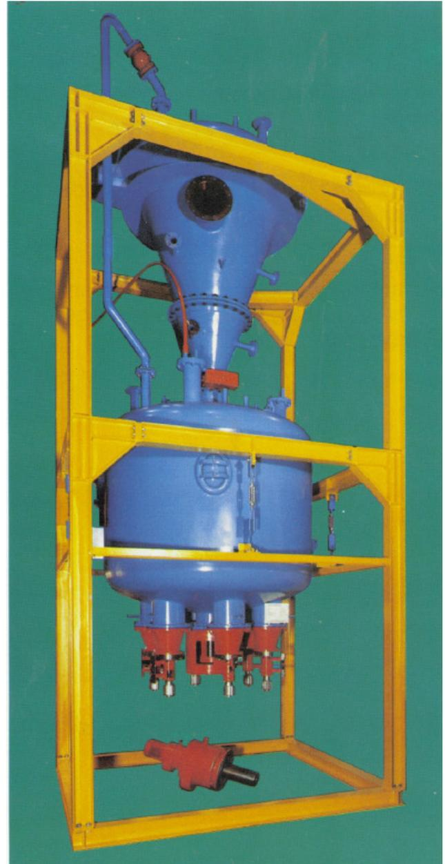
Abb. 1: Pneumatischer Dosierförderer: 5000 l Inhalt mit 6 Förderrohr-Abgängen, Förderleistung ca. 1500kg/h pro Förderrohr
